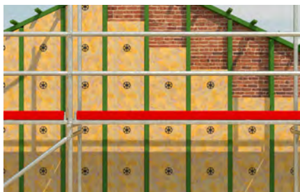
Materiali di isolamento in facciate retro-ventilate.
