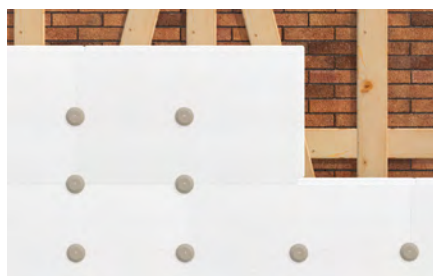
Fissaggio di pannelli isolanti in fibra di legno su struttura in legno massiccio.
