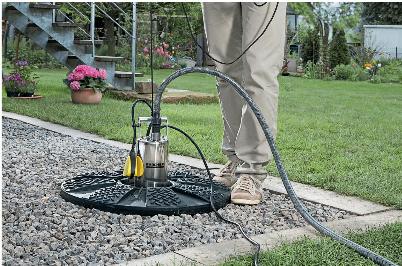
La BP 2 per Cisterne è dotata di corpo e manicotti di acciaio inox, raccordo tubo  $\frac{3}{4}$ " e 1" con valvola di non ritorno e fascetta ferma tubo, galleggiante con livello di accensione regolabile
